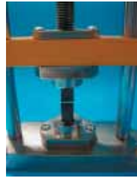
bm003 Bilanciere "maxi " Pressa idraulica per riduzione minerali. Costruzione solida in acciaio Pressione massima 5.000 kg. Dimensioni: larghezza 300 mm, profondità 150 mm, altezza 630 mm Apertura massima: 170 mm Diametro punta: 30 mm Peso: 35 Kg.
