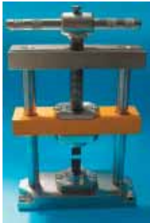
bm001 Bilanciere " mini " Pressa manuale per riduzione minerali. Costruzione solida in acciaio Dimensioni: larghezza 150 mm, profondità 60 mm, altezza 240 mm Apertura massima: 60 mm Diametro punta: 12 mm Peso: 4 Kg.
